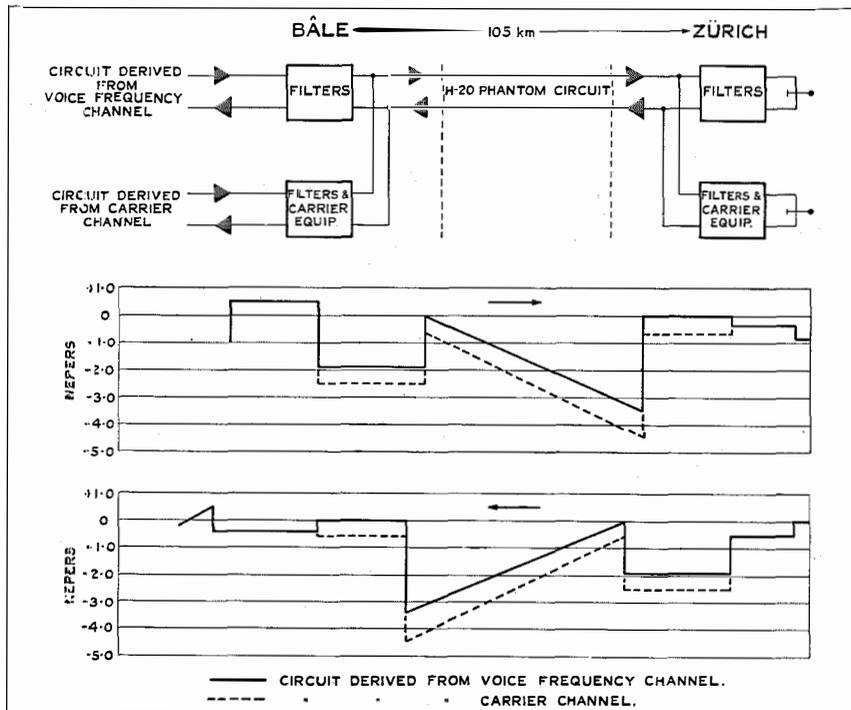
Fig. 12—Level Diagram.
